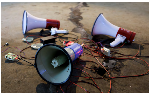
Gedemonteerde megafoons, potentiometer, LDR, WAGO-connectoren, AC/DC-omvormer, draden
